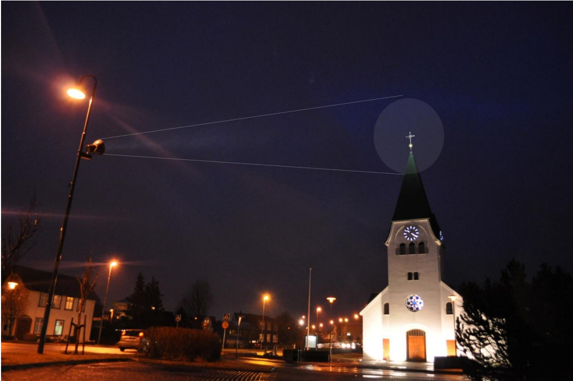
Ljósabúnaður Hafnarfjarðarkirkju er dæmi um óheppilega lýsingu neðan frá. Sérstaka athygli vekur lýsing tumkrossins þar sem undir 10% af ljósinu nýtist. Stefna og horn geisla hafa verið merkt inn á myndina til áherslu.
