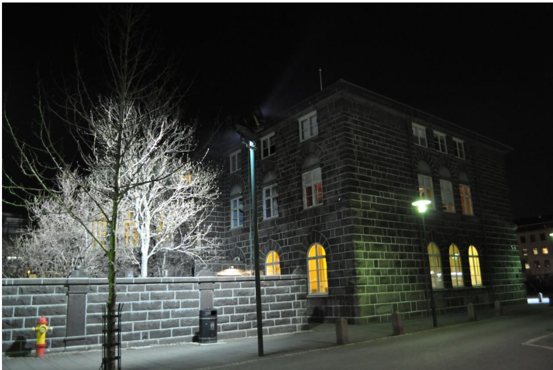
Alþingishúsið og þinghúsgarðurinn. Götuljós varpa birtu á á vegg byggingarinnar en flóðljós beinist af ókunnum sökum að tré í garðinum. Ofan á því er annað flóðljós sem beint er upp á turn Dómkirkjunnar. Götuljósín eru illa skermuð, þ.e. kúlulaga lukt hefur toppskerm en lýsing fer upp yfir 70° horn (sjá 15. kafla). Birta ljósskeranna er mild í samanburði við öflugla lýsingu á trénu. Þeim geisla er þó beint niður á við, sem er jákvætt, öfugt við flóðljósið á Dómkirkjunna sem beinist upp í himininn.
